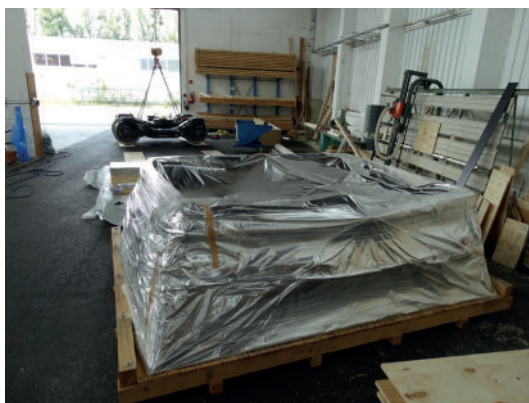
In der Halle werden die Drehgestelle angehoben (Foto oben) und auf eine Sonderholzkonstruktion gehoben und verpackt.
