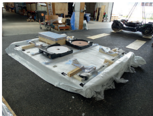
In der Halle werden die Drehgestelle angehoben (Foto oben) und auf eine Sonderholzkonstruktion gehoben und verpackt.
